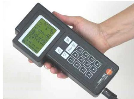
اندازه گیری و ذخیره پارامترهایی از قبیل درجه حرارت ، رطوبت نسبی ، سرعت سیال ، فشار و افت فشار
