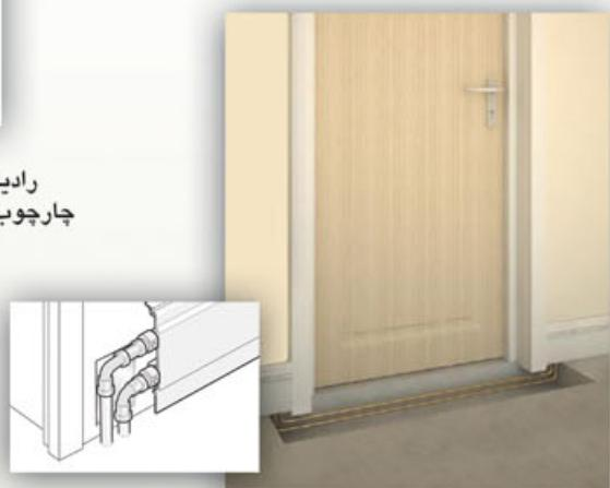
در برخورد با چارچوب درب ها یا پنجره ها دو روش جهت ادامه مسیر ThermaSkirt® وجود دارد. یکی اینکه از قطعات تبدیل ابتدا و انتهای لوله ها استفاده نموده و مسیر را توسط لوله های رفت و برگشت از کف ادامه داد. یا اینکه از پروفیل های خاص طراحی شده برای چارچوب درب ها استفاده نمود و با این کار سطح تبادل حرارتی را نیز افزایش داد.
