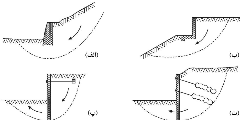
شکل ۷ - ۶ - ۱ نمونه‌هایی از حالت‌های حدی پایداری کلی در دیوارهای نگهبان.
