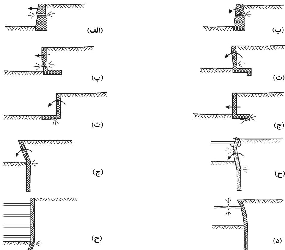
شکل ۷-۶-۵ نمونه‌هایی از حالت‌های حدی گسیختگی سازه‌ای در دیوارهای نگهبان.
